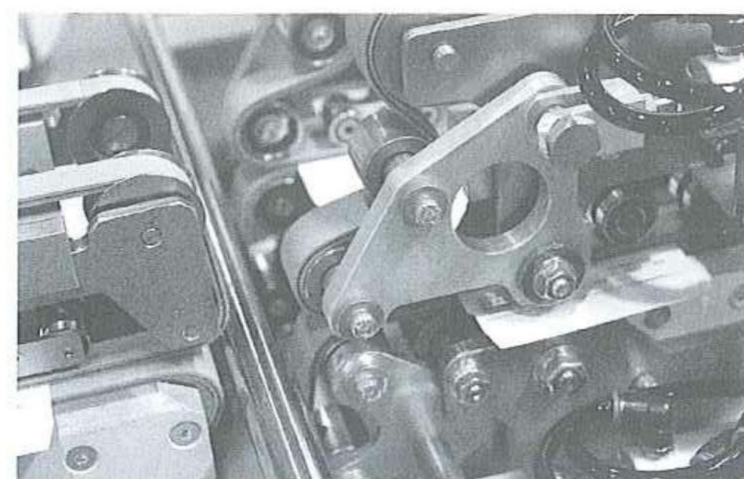
スムーズに不良 blanks 排出を促すエジェクト装置
